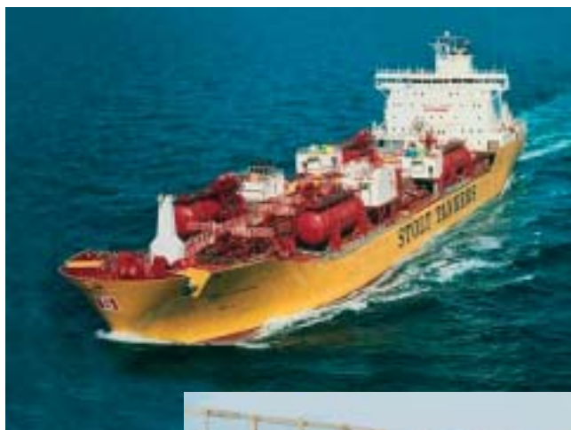
Fig. 4. Danskbygget kemikalietankerskib med to store affugtere for tanktørring.
