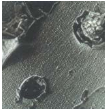
Fig.2. Virkningerne af korrosion på elektronisk kontaktmateriale. Kilde: Chalmers Tekniske Højskole, Gøteborg.
